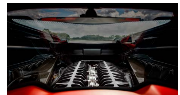
Schönheit unter Glas: 6,2-Liter-LT- V8-Motor.
