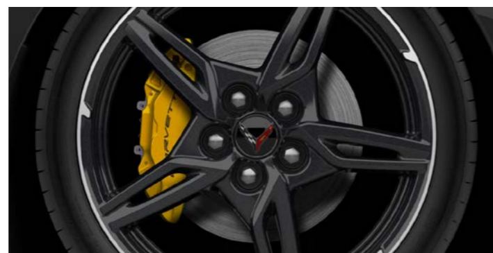
Lackierte Bremssättel in Velocity Yellow
