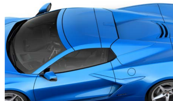
Versenkbares Hardtop beim Cabriolet, das sich bei bis zu 50 km/h öffnen lässt.
