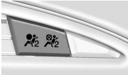
Al arrancar el vehículo, el símbolo del indicador de estado del airbag del acompañante se encenderá y apagarán durante varios segundos como control del sistema. Después, durante varios segundos más, el indicador de estado encenderá el símbolo de activado o desactivado para informar del estado del airbag frontal del acompañante delantero del asiento exterior.
