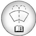
Abra el tapón del símbolo del lavaparabrisas. Añada líquido de lavado hasta llenar el depósito. Consulte *Vista del compartimento del motor* ⇨ 241.
