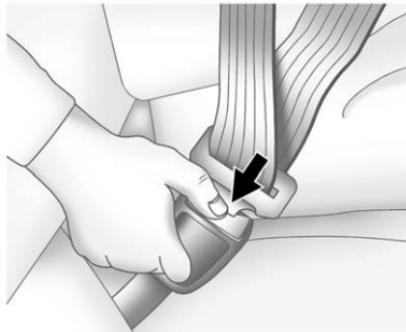
Para desabrochar el cinturón, presione el botón de la hebilla. El cinturón debería volver a su posición de almacenamiento.
