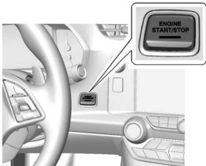
El vehículo está equipado con un sistema de encendido electrónico sin llave con arranque mediante un pulsador.
