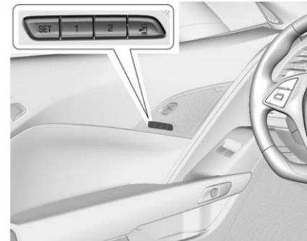
Si el vehículo está equipado con dicha función, los botones 1, 2, SET (Ajustar) y
