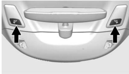
Las luces de lectura se encuentran en la consola del techo. Las luces se encienden cuando se abre una puerta. Con las puertas cerradas, presione los botones de las luces para encender cada una de ellas.
