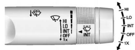
La palanca del limpia/lavaparabrisas se encuentra en el lado derecho de la columna de dirección.
