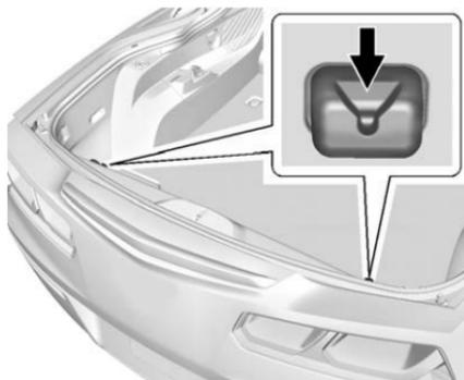
3. Alinee los pasadores del panel de techo trasero para que encajen en las ranuras de la parte trasera de la zona de carga.
