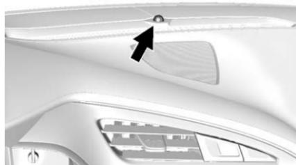
Hay un sensor de luz en la parte superior del tablero de instrumentos. No cubra el sensor; de hacerlo, los faros se encenderán cuando no los necesite.
