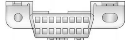
El conector de diagnóstico se encuentra debajo del tablero de instrumentos, a la izquierda del volante. Los dispositivos conectados que no se usan para llevar a cabo una prueba de mantenimiento/inspección de emisiones o para revisar el vehículo podrían afectar al funcionamiento del vehículo. Consulte *Equipo eléctrico complementario* ⇨ 234. Si necesita asistencia, consulte al concesionario.
