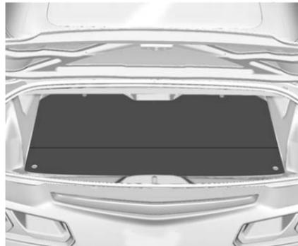
Con la capota subida, la partición del maletero puede desengancharse y colocarse plana para aumentar el espacio de carga del maletero.
