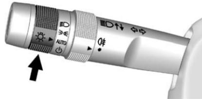
El mando de las luces exteriores se encuentra en la palanca de los intermitentes.
