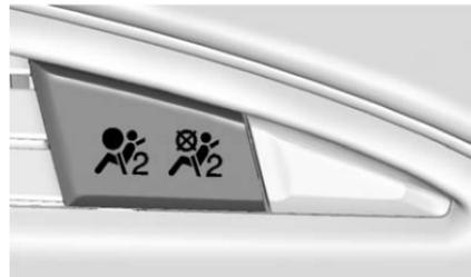
El sistema de detección de ocupantes desactivará el airbag delantero del acompañante delantero exterior en determinadas
