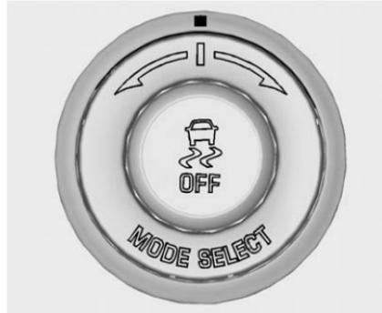
Para seleccionar un modo en gestión de tracción, gire el mando del control de conducción magnético/gestión de tracción MODE SELECT de la consola central.
