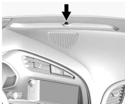
El testigo situado en el tablero de instrumentos, cerca del parabrisas, indica el estado del sistema.
