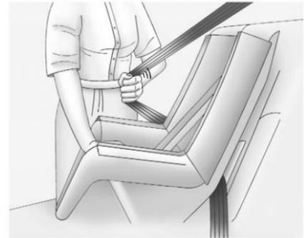
5. Tire del cinturón de hombro para extraerlo completamente del retractor y bloquear la cerradura. Cuando se bloquea el retractor, el cinturón puede ajustarse pero no puede extraerse del retractor.
