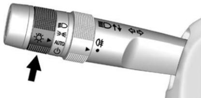
El conmutador de las luces exteriores está en la palanca de los intermitentes.
