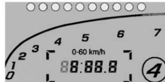
**Cronometraje :** Muestra un cuenta-revoluciones lineal, la marcha seleccionada, los testigos del cambio de marcha y un cronómetro de vueltas o temporizador de rendimiento. El contenido del temporizador de rendimiento o cronómetro de vueltas que se muestra depende
