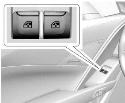
Pulse el interruptor hasta el primer retén para bajar la ventanilla. Empuje hasta el primer retén para subir la ventanilla. Suelte para detenerla en la posición deseada.
