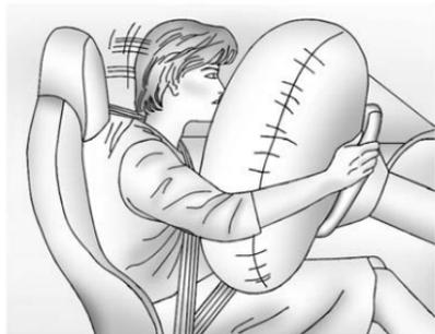
El airbag frontal del conductor está en el centro del volante.
