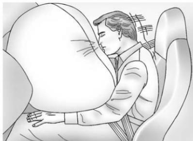
El airbag frontal del acompañante está en el tablero de instrumentos, en el lado del acompañante.
