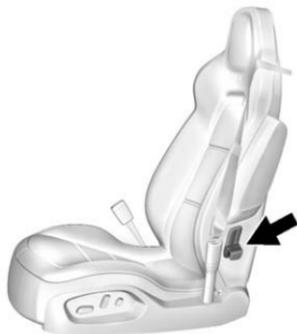
Si está equipado, levante el anclaje para plegar el respaldo hacia delante.
