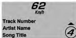
**Audio:** Peut s'afficher lorsqu'une nouvelle source, un nouvel émetteur radio ou un nouveau type de média est sélectionné.
