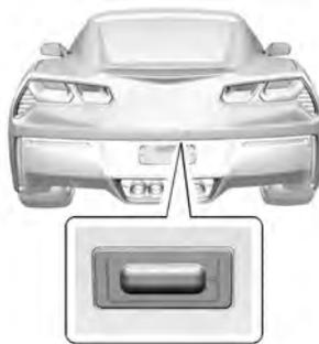
Appuyer sur le pavé tactile de déverrouillage pour ouvrir le coffre si la télécommande RKE est à moins de 1 m (3 pi).
