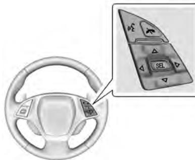
Utiliser la commande au volant du côté droit pour ouvrir et faire défiler les différentes options et les différents affichages.
