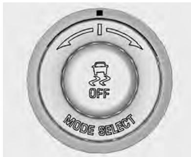
Pour sélectionner un mode tout en étant en PTM, faire tourner le bouton de commande de suspension magnétique/gestion antipatinage de performance **MODE SELECT**, sur la console centrale.
