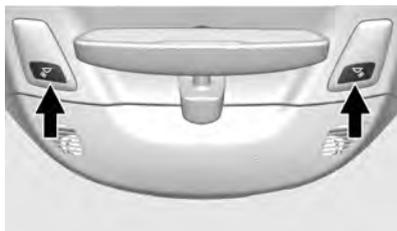
Les lampes de lecture se situent dans le vide-poches de pavillon. Les liseuses s'allument lorsqu'une porte est ouverte. Lorsque les portes sont fermées, appuyer sur les boutons de lampe pour allumer chaque lampe.
