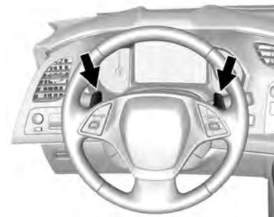
La fonction Active Rev Match (ARM) contribue à un passage souple des rapports en accordant le régime moteur au rapport suivant sélectionné. Le système est activé et désactivé en appuyant sur les palettes marquées REV MATCH sur le volant de direction. Consulter *Fonction Rev Match active* à la page 9-36.
