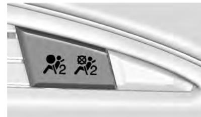
Lorsque le véhicule démarre, le témoin de statut de l'airbag de passager allumera le symbole d'activation/désactivation pendant quelques secondes à titre de test. Ensuite, après plusieurs secondes, le mot ON (marche) ou OFF (arrêt)
