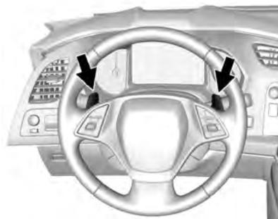
Le système de changement de vitesse manuel par palette peut être utilisé en D (conduite) ou M (mode manuel). Le système est activé en
