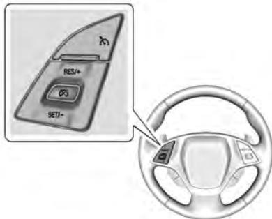
**⏻ (marche/arrêt):** Enfoncer pour activer et désactiver le régulateur de vitesse. Un témoin blanc s'affiche au combiné d'instruments lorsque le régulateur de vitesse est tourné en position de marche.
