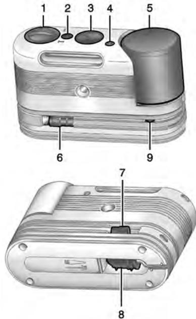
1. Commutateur (Produit d'étanchéité/Air ou air seulement).
