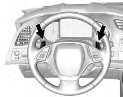
Le système est activé et désactivé en appuyant sur les palettes marquées REV MATCH au volant. Le système doit être activé à chaque niveau cycle d'allumage.
