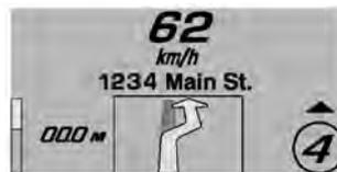
**Navigation:** L'information de navigation pas à pas peut s'afficher lorsque la navigation est active et qu'une manœuvre va s'avérer nécessaire. S'affiche jusqu'à la fin de la manœuvre est achevée puis le HUD retourne à la vue précédente.
