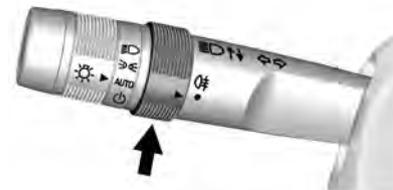
Tourner l'anneau jusqu'à  $\text{O} \frac{1}{2}$  et le relâcher pour allumer et éteindre les feux antibrouillard arrière.
