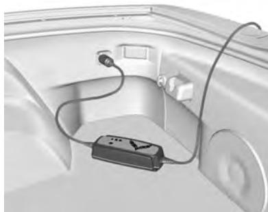
Certains véhicules disposent d'un ensemble d'entretien pour la batterie. Suivre les instructions fournies avec l'ensemble d'entretien de la batterie pour garder la batterie chargée lorsque le véhicule n'est pas utilisé. Brancher l'appareil pour batterie dans la prise d'alimentation des accessoires (APO) uniquement. La fonction APO avant est désactivée lorsque le contact est coupé.
