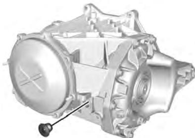
Pour obtenir un relevé précis, le véhicule doit être sur une surface de niveau.
