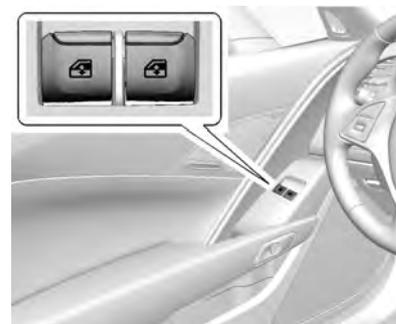
Enfoncer le commutateur jusqu'au premier cran pour abaisser la vitre. Tirer jusqu'au premier cran pour lever la vitre. Relâcher pour arrêter à la position désirée.
