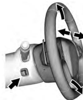
Appuyer sur la commande pour déplacer le volant de direction inclinable et télescopique vers le haut, le bas, l'avant ou l'arrière.
