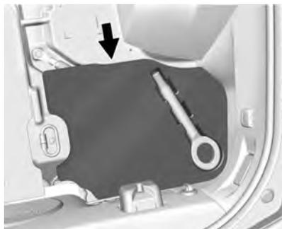
5. Déposer le couvercle de la batterie et localiser les cosses positives (+) et négative (-).
