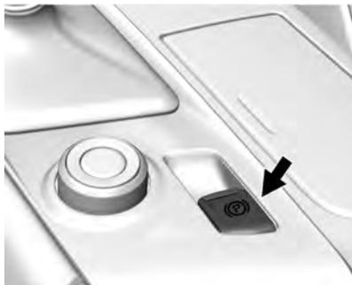
Le véhicule possède un frein de stationnement électrique. Le commutateur se trouve sur la console centrale. L'EPB peut toujours être activé, même si le contact est coupé. Pour éviter de décharger la batterie, éviter les cycles répétés de la fonction EPB lorsque le moteur ne tourne pas.
