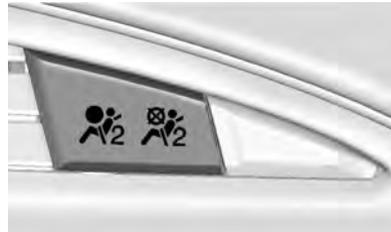
Le système de détection de passager désactive le coussin gonflable frontal de passager avant extérieur dans certaines conditions. Aucun autre coussin anti-chocs n'est affecté par le système de détection de passager. Consulter *Système de détection de passager à la page 3-22.*
